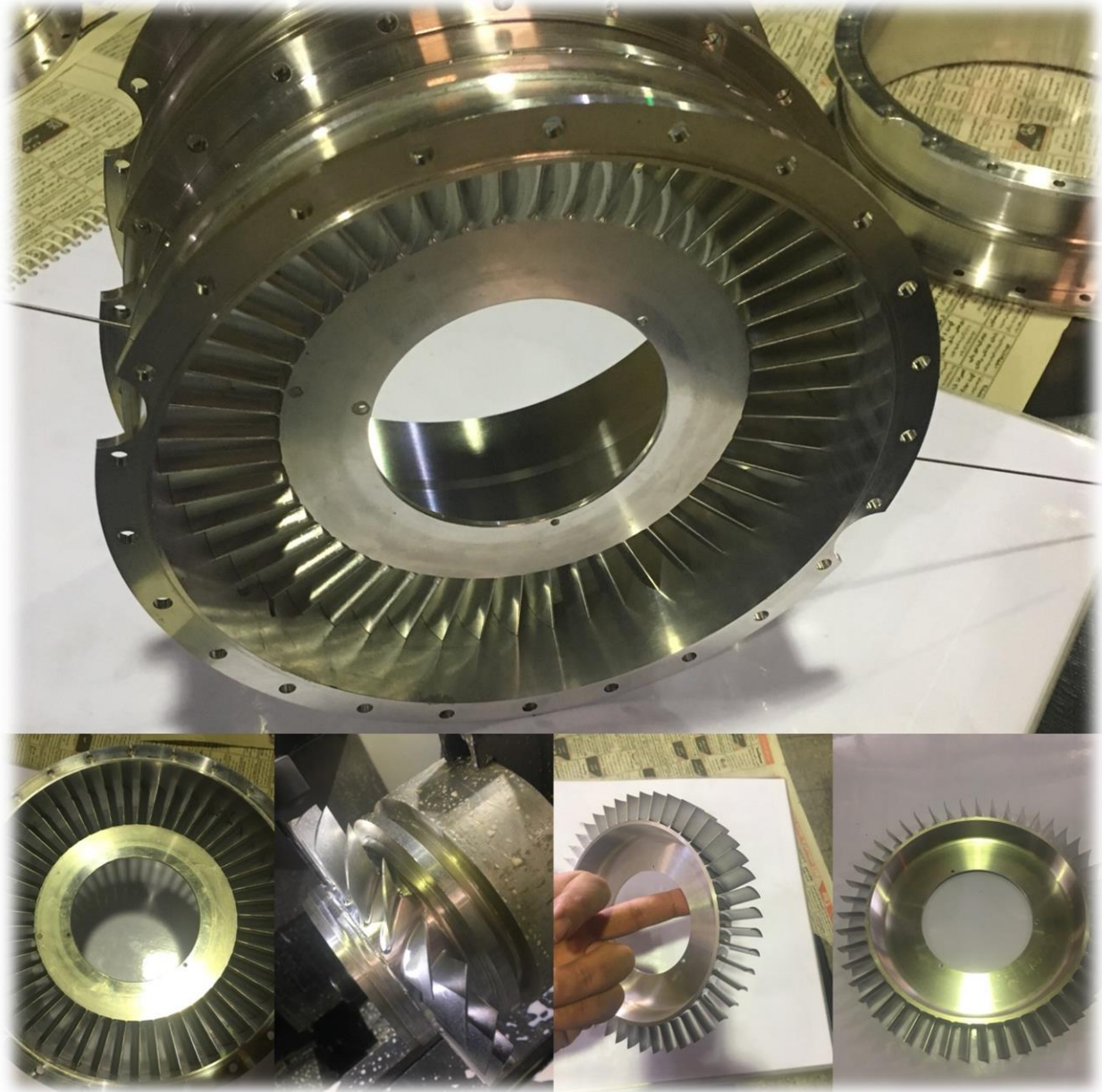
تولید مجموعه کامل COLD SECTION کمپرسور موتور توربو جت
