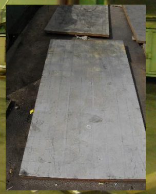
راکتور با بدنه فولاد کربنی با پوششی از فولاد SS 316L برای محافظت در برابر خوردگی (Explosive Cladding) (در حال گذراندن تست رادیوگرافی)
