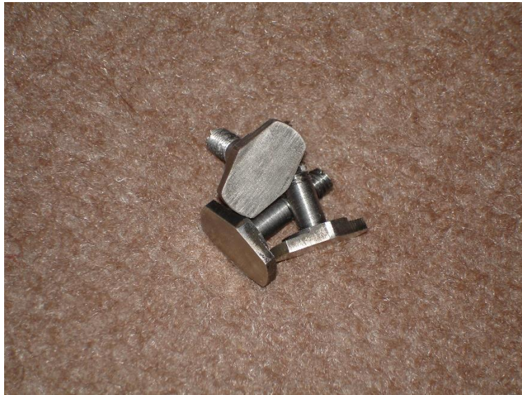
حسگر جیوه برای پتروشیمی ماهشهر (کلدینگ 0/3 میلیمتر پلاتین روی فولاد)
