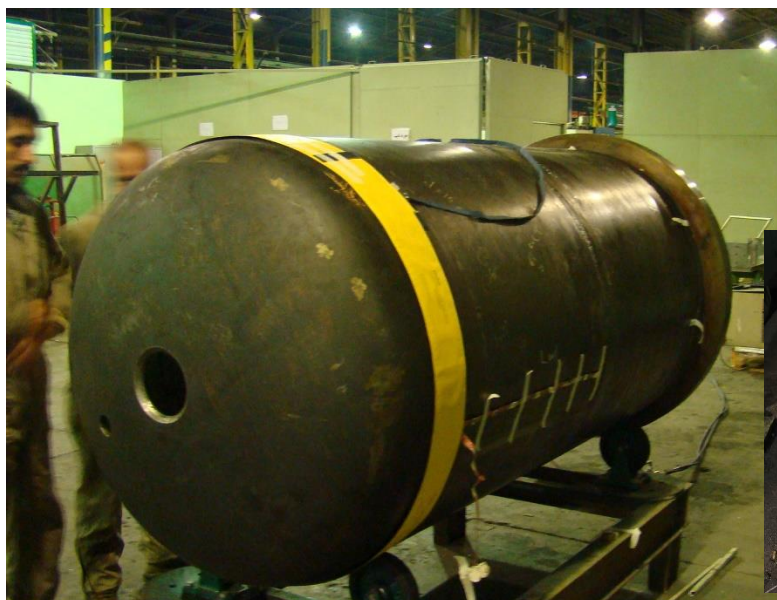
راکتور با بدنه فولاد کربنی با پوششی از فولاد SS 316L برای محافظت در برابر خوردگی (Explosive Cladding) (در حال گذراندن تست رادیوگرافی)
