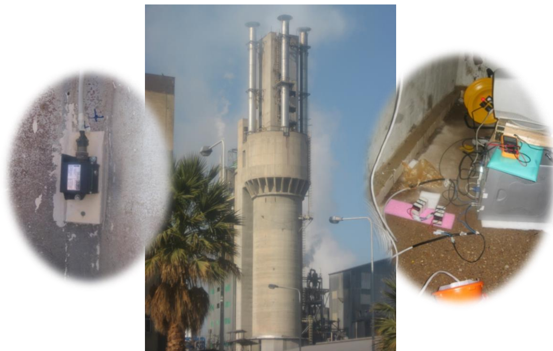
پروژه تست مودال (AVT) برج مجتمع پتروشیمی شیراز (واحد آزمون‌های مکانیکی/سازه‌ای)
