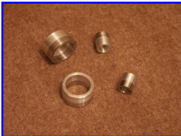
قطعه ساخته شده برای صنایع نظامی ( جوشکاری آلومینیم روی فولاد ضد زنگ)
